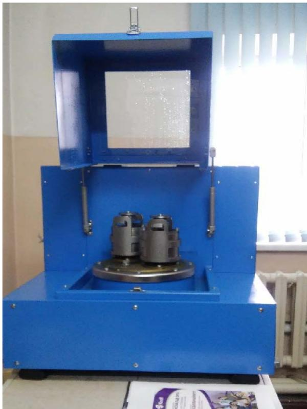
Рисунок 3 - Шаровая планетарная мельница типа «Агитатор 2S»
